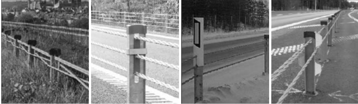
Figur 13 Foton som illustrerar utseendet på fabrikat av ställineräcken som är godkända i Sverige: Från vänster Brifen, Safence, Safe Road och Safety Line (Vägverket, uttryckning på 2+1 väg, hemsida)
